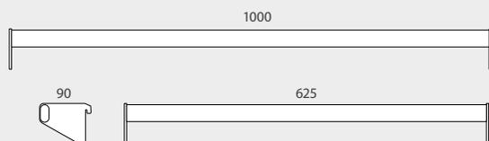
Este Riel Metálico Oval, es ideal para mostrar y soportar el peso de varias brazos portaperchas. Además, esta fabricado de tubo de acero y su instalación es rápida y sencilla. Disponible en dos medidas.
